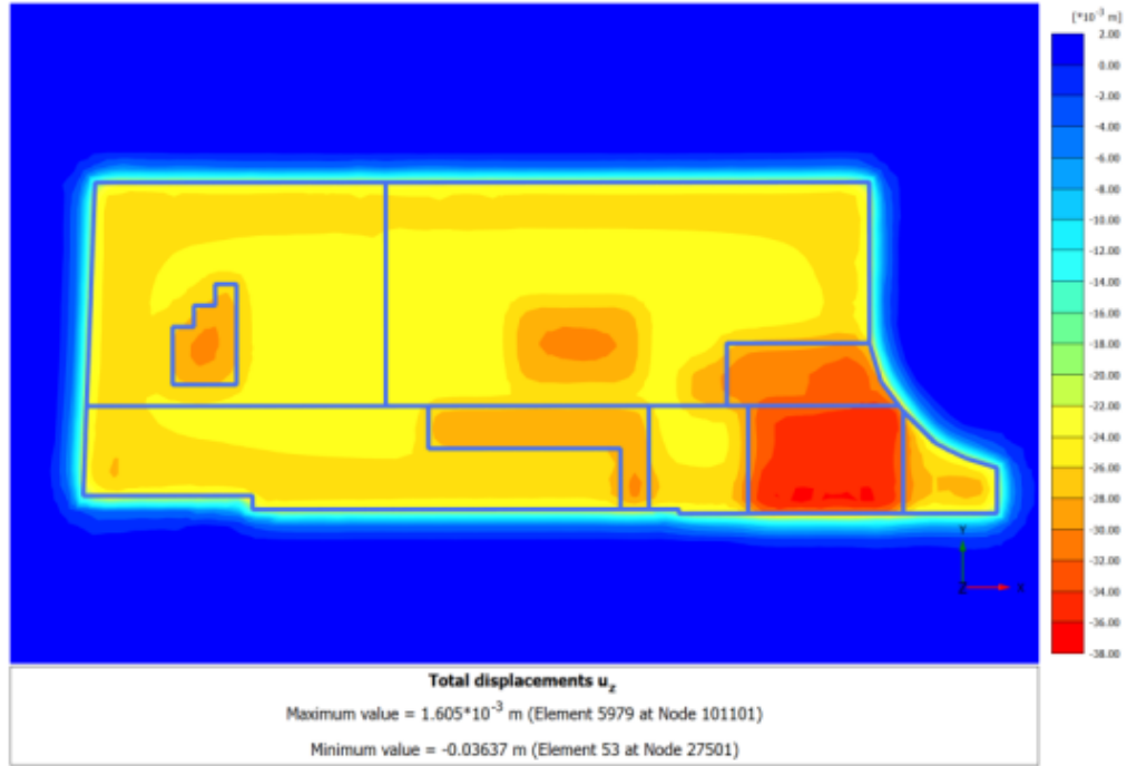
Şekil 8. Üç Boyutlu Analiz Sonucunda Düşey Deplasmanlar
