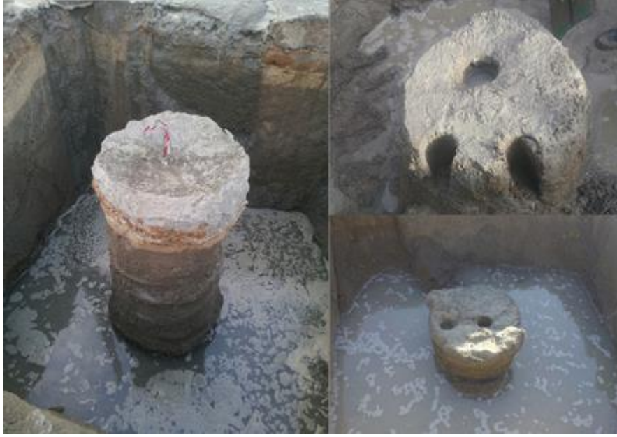
Şekil 10. Kalite Kontrol Testleri: Merkez ve Köşe Karotlar
